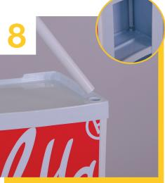
Führen Sie die Stangen durch die entsprechenden Aufnahmen in der Deckelplatte hindurch und stecken Sie diese danach in die entsprechenden Aufnahmen des Zwischenbodens.
