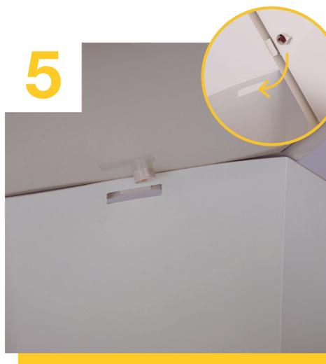
Zum Schluss legen Sie die Deckelplatte auf den Thekenkörper auf und haken diese in den entsprechenden Aussparungen ein.
